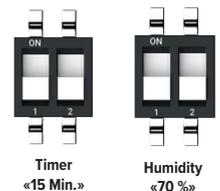
Das Gebläse schaltet sich automatisch ein, wenn der eingebaute Luftfeuchtigkeitssensor eine Überschreitung von 70% feststellt (siehe **ABSCHNITT 1**) und läuft so lange, bis der Luftfeuchtigkeitssensor einen Rückgang auf 70% oder weniger feststellt (siehe **ABSCHNITT 1**). Das Gebläse läuft dann 15 Minuten lang (siehe **ABSCHNITT 2**) und schaltet dann ab.
