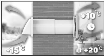
3.1 Im Automatikbetrieb saugt der Rekuperator beim Einschalten Luft aus dem Raum ab. Nach Ablauf der eingestellten Schaltzeit (60, 70, 80 oder 90 Sekunden) wird automatisch auf Zuluft umgeschaltet. Bei einer Außentemperatur von -15°C strömt +10°C Luft in den Zuluftkanal. Der Zuluftbetrieb bleibt für die eingestellte Zeit bestehen, ebenso der Abluftbetrieb. Danach wird auf Abluft umgeschaltet.
