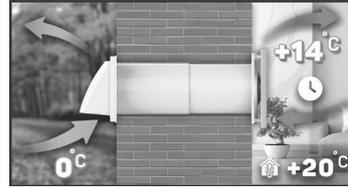
3.2 Im Automatikbetrieb saugt der Rekuperator beim Einschalten Luft aus dem Raum ab. Nach Ablauf der eingestellten Schaltzeit (60, 70, 80 oder 90 Sekunden) wird automatisch auf Zuluft umgeschaltet. Bei einer Außentemperatur von 0°C wird dem Raum +14°C Zuluft zugeführt. Die Zuluft bleibt wie die Abluft für die eingestellte Zeit eingeschaltet. Danach wird auf Abluft umgeschaltet.
